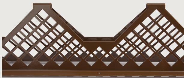
**AC\_ griglia di partenza parapasseri:** in acciaio zincato 12/10 e verniciato a polveri epossidiche, con la funzione di parapasseri e di sostenere il carico gravante della falda (ingresso d'aria 400 cm<sup>2</sup>/m). \*Passi disponibili: 19-21-23 cm.
