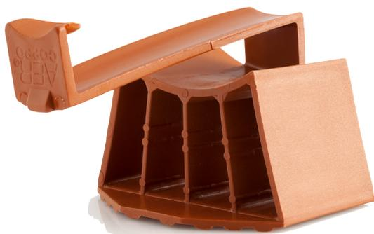
**PC\_Piedino AERcoppo® di rialzo e bloccaggio:** in polipropilene copolimero stabilizzato ai raggi U.V.A.; elemento di rialzo ed ancoraggio, da applicare sul retro di ogni coppo canale. La staffa a Z permette di agganciare il coppo successivo retrostante consentendo così la creazione di una maglia catenaria. **Non richiede il fissaggio a mezzo meccanico (attraverso chiodatura) sul piano di posa.**
