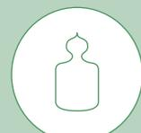
il *Piedino* è in polipropilene copolimero e pesa solamente 36 g. Sono necessari 15 *Piedini* a m<sup>2</sup>, per un totale di 0,54 Kg/m<sup>2</sup>.
